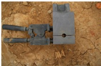
图 1 某厂家生产的模具开口空隙很大
