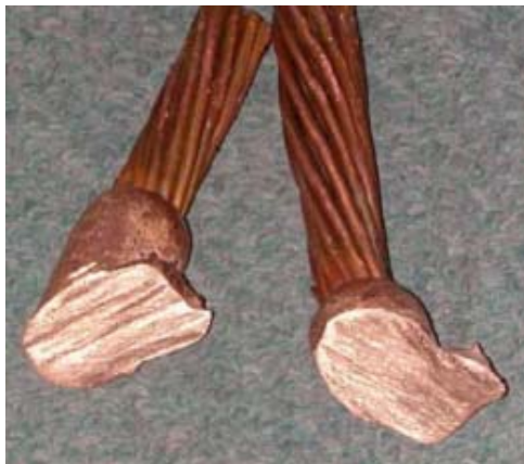
图 3 好的放热焊接做的接头，接合面无任何空隙
